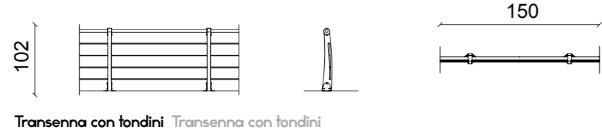
Transenna con fondini Transenna con fondini
